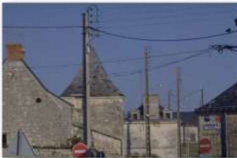
Câbles de distribution BT aériens (torsadé et fils nus) :
