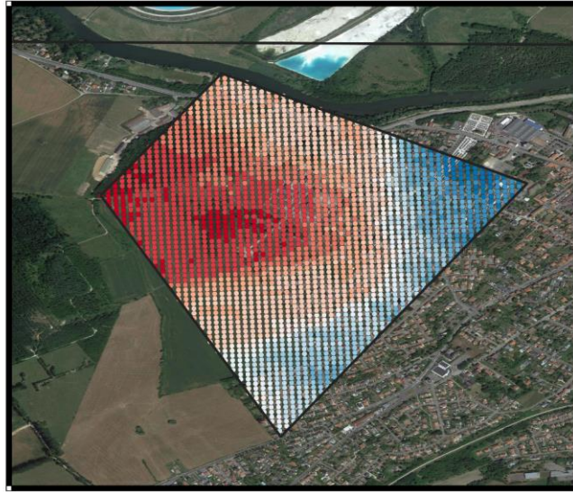
Combinaison inSAR et nivellement Vitesses verticales [mm/an] Du 01/08/2018 au 01/06/2020 ● -22 - -19 ● -19 - -16 ● -16 - -12 ● -12 - -7 ● -7 - -2 ● -2 - 0 ● 0 - 2 ● 2 - 5 ● 5 - 7 ● 7 - 10 ● 10 - 12 ● 12 - 15
