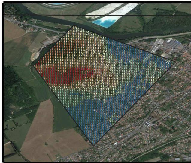
Combinaison inSAR et nivellement Vitesses est [mm/an] Du 01/08/2018 au 01/06/2020 ◆ -3 - -2 ◆ -2 - -1 ◆ -1 - 0 ◆ 0 - 1 ◆ 1 - 2 ◆ 2 - 5
