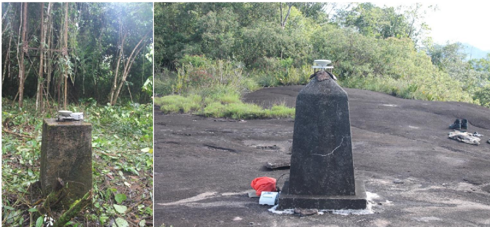
Photos 04 et 05 : GPS géodésique installé sur les bornes (Trijonction, borne 1)
