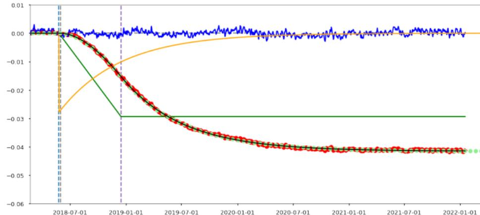
Fig. Rouge : première composante de l'ACP. Ligne noire : modèle estimé. Bleu : résidus. Vert : historique de la pression imposée à l'extrémité de la conduite.
