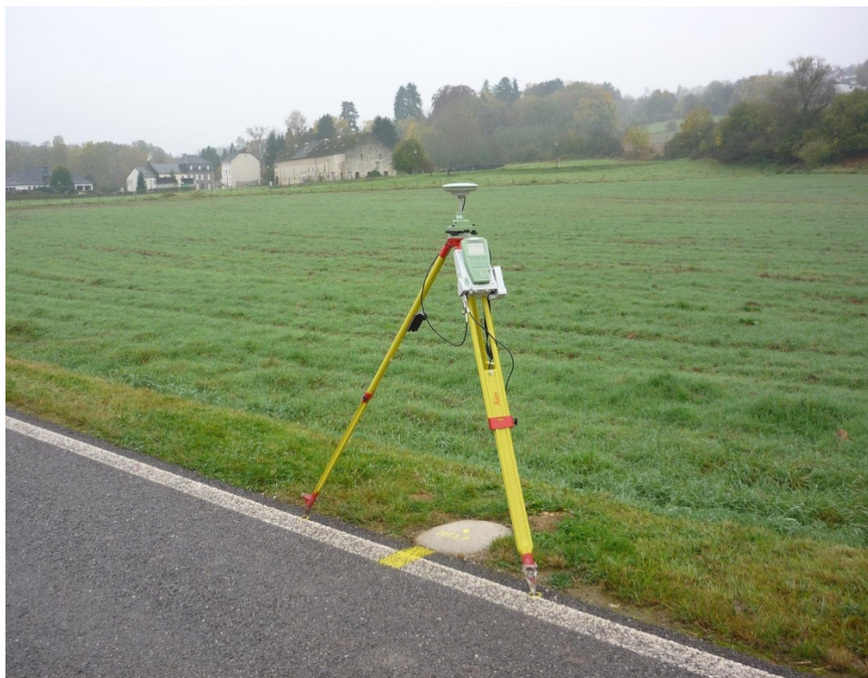
Figure 12 : Exemple d'installation d'un récepteur GNSS en mode statique.
