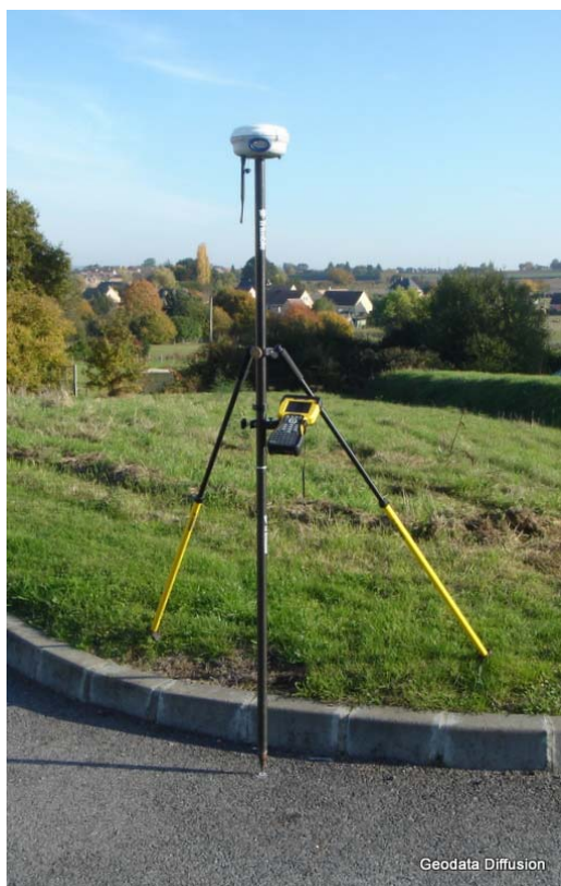
Figure 1 : Dispositifs de stabilisation de l'antenne pour du positionnement cinématique et statique
