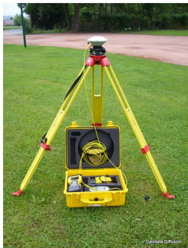
Figure 1 : Dispositifs de stabilisation de l'antenne pour du positionnement cinématique et statique
