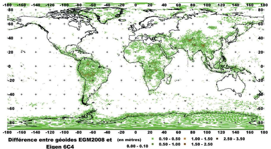
Figure 21. Différence entre les géoïdes EGM2008 et EIGEN6C4.
