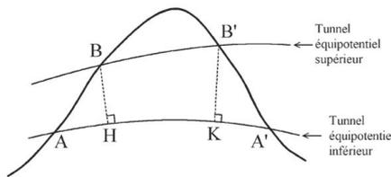
Figure 8. Nivellement géométrique : dépendance au chemin suivi
