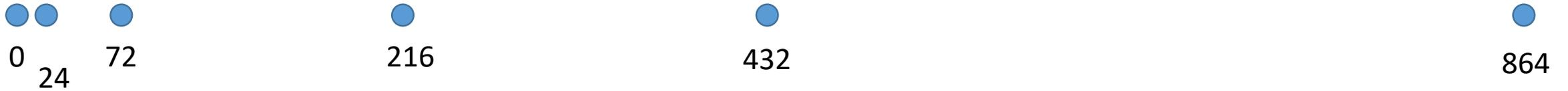
Comparaison d'une ligne de 864 m avec un étalon de quartz de 1 m par une technique d'interférométrie en lumière blanche
