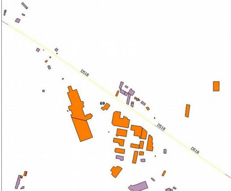
*Exemple de brins du référentiel source (BD Topo de l'IGN) contigus, sans intersection ni bifurcation, d'un même itinéraire D518 et susceptibles d'être réassemblés en un même tronçon homogène vis à vis du trafic*
