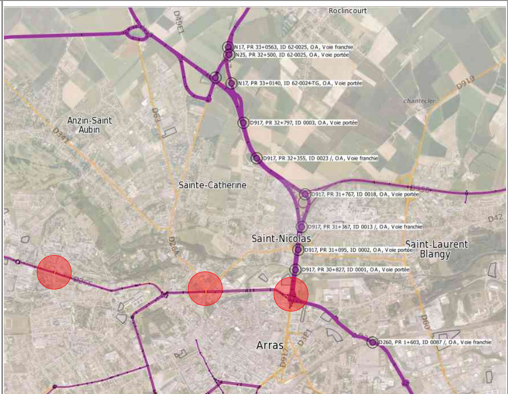
Réseaux interdépartementaux de Transports Exceptionnels 72T, 94T et 120T au nord d'Arras, échelle 1/25000ème réduite à environ 60 % de taille d'image
