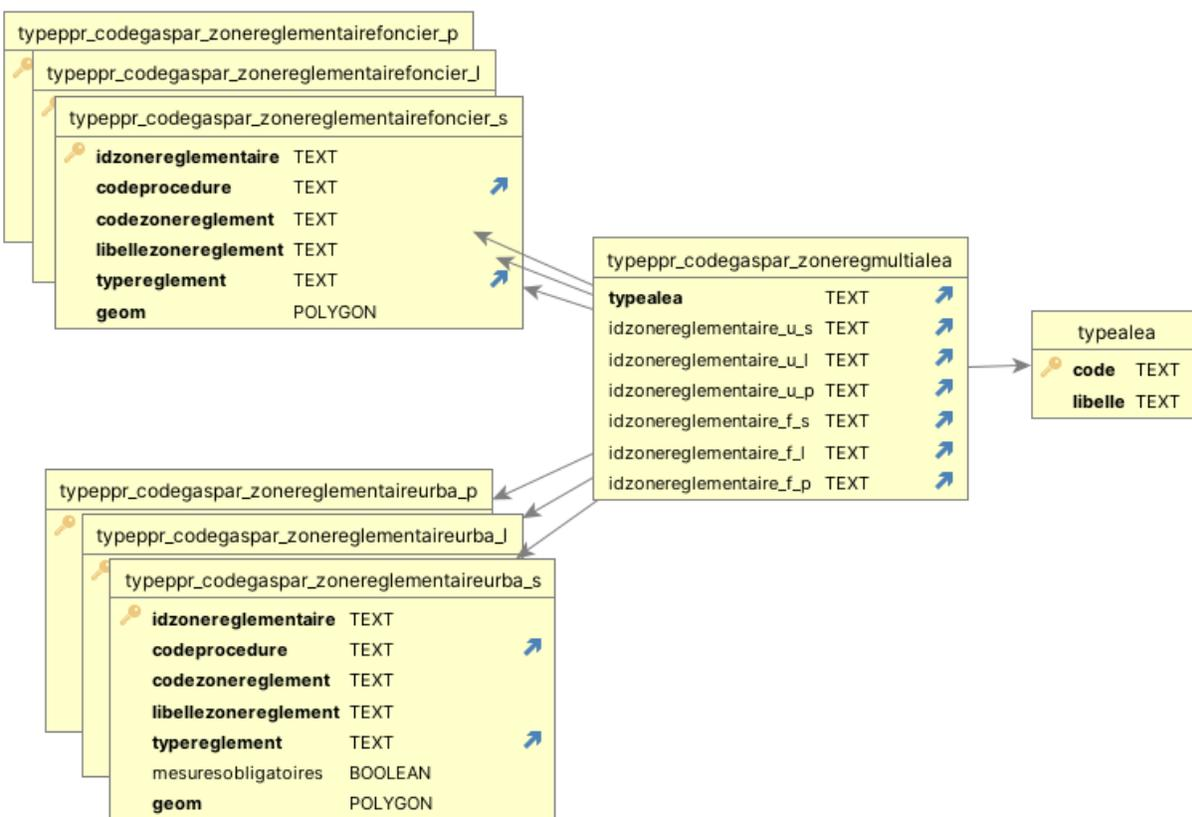
Figure 19 : Implémentation des tables de zones réglementaires multirisques
