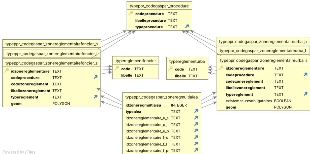
Figure 16 : Diagramme des tables de la thématique Zonage Réglementaire
