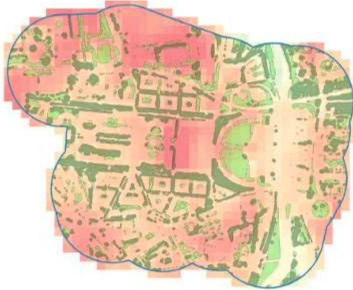
Quartier Antigone à Montpellier : températures de surface en arrière-plan, en haut : classes d'occupation du sol à haute résolution dérivées de Pléiades (vert <3 m, vert foncé > 3m)
